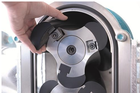
Figura 5: Bomba de lóbulos com ponta de borracha (Fonte: Borger)
