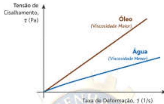
Figura 4 - Diagrama Tensão x Deformação para fluidos newtonianos (Fonte: Engenharia e Cia)
