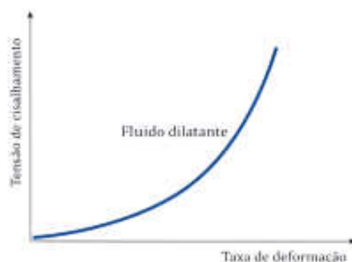
Figura 6 - Diagrama Tensão x Deformação para fluidos dilatantes (Fonte: Engenharia e Cia)
